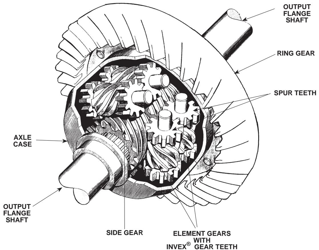
Figure 11-1. ZEXEL Torsen<sup>®</sup> Differential.
